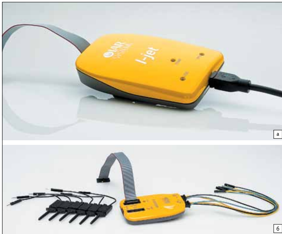
Рис. 4. Внешний вид адаптера: а) I-Jet; б) I-Score
