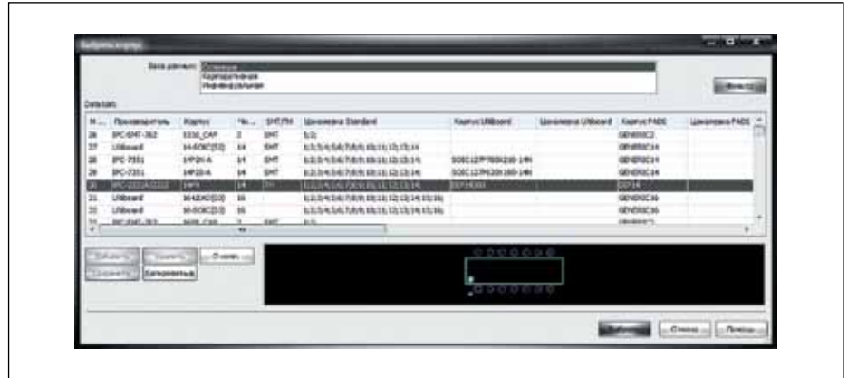
Рис. 14. Окно «Выбор корпуса» для цифрового компонента
