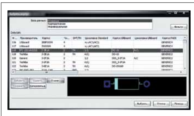
Рис. 3. Окно «Выбрать корпус» для аналогового компонента
