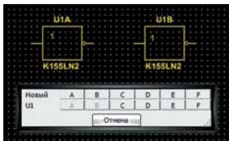
Рис. 16. Панель секций и две секции символа разработанного цифрового компонента в рабочем поле программы
