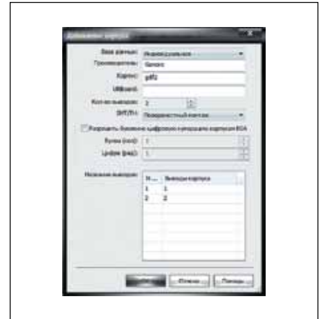
Рис. 2. Окно «Добавление корпуса» для аналогового компонента
