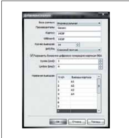
Рис. 13. Окно «Добавление корпуса» для цифрового компонента
