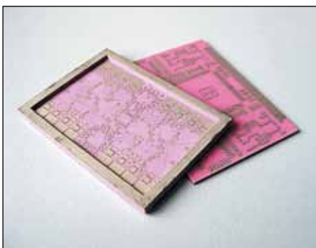
Рис. 5. НТСС-корпус и плата (36×50 мм) керамического модуля (ФГУП «Субмикрон»)
