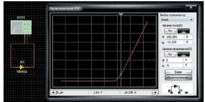
Рис. 4. Пример подключения характериографа-IV к диоду и ВАХ компонента
