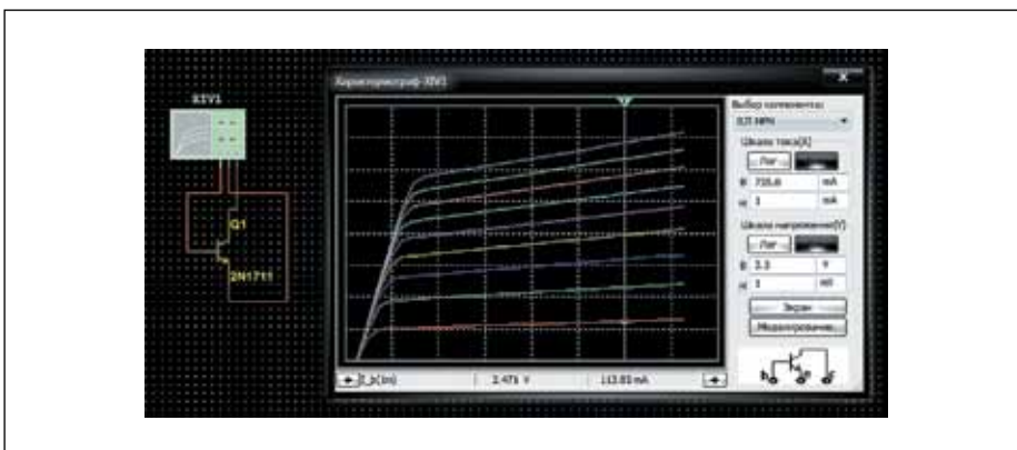
Рис. 10. Пример подключения характернографа-IV к pnp-транзистору и VAX компонента
