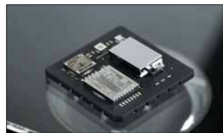
Рис. 8. Внутреннее устройство датчика MS8000
