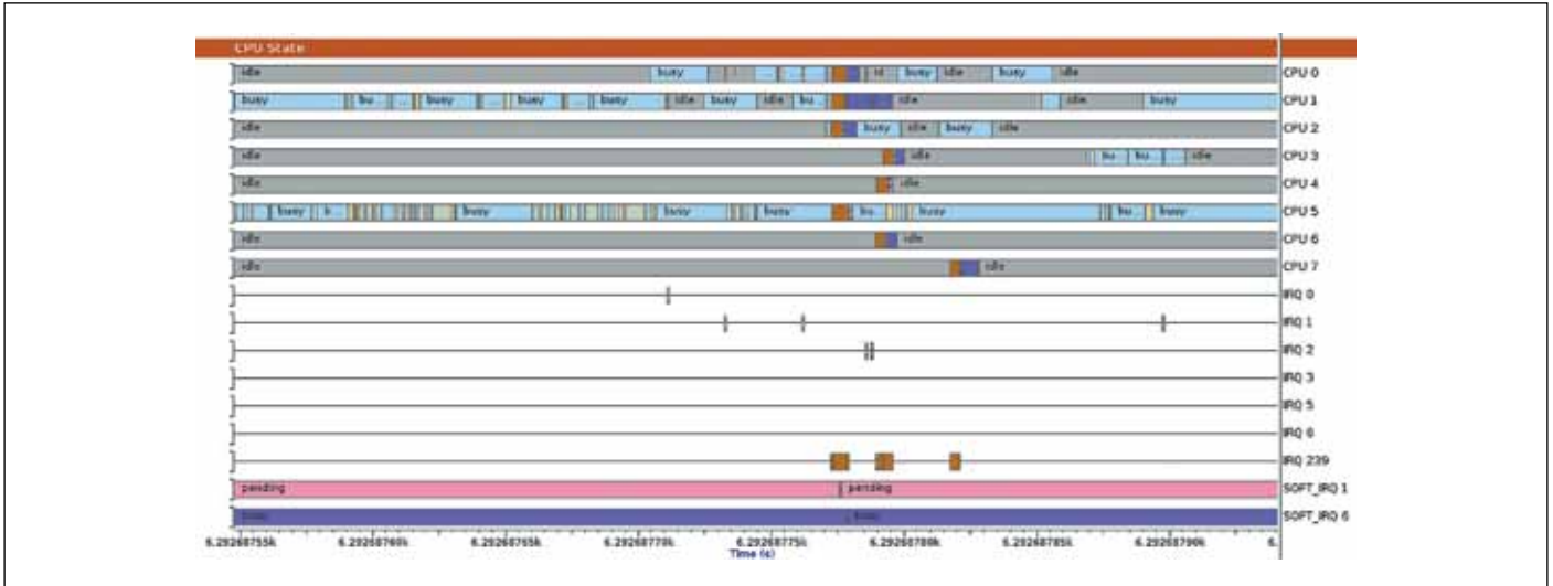
Рис. 10. Просмотр состояния CPU в окне Sourcery Analyzer
