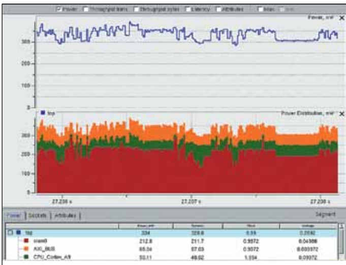
Рис. 8. Просмотр распределения мощности
