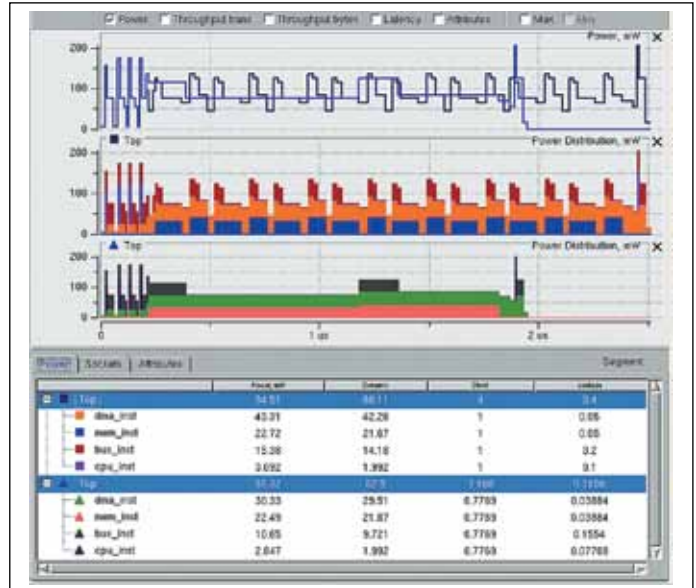
Рис. 9. Сравнение распределения мощности для двух архитектур
