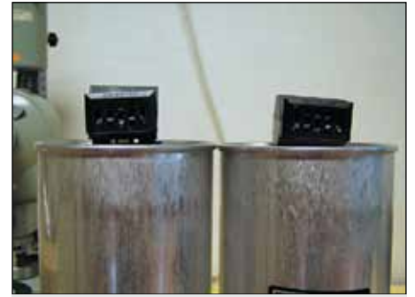
Рис. 2. Конденсаторы без складки безопасности на корпусе
