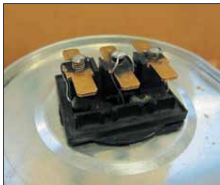
Рис. 3. Неправильное размещение разрядных резисторов
