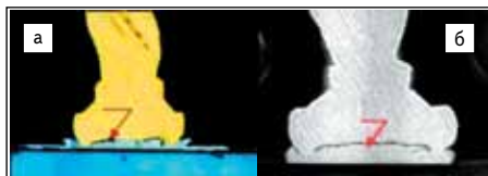
Рис. 4. Образование пустот между золотым шариком на золотой проволоке диаметром 20 мкм и алюминиевой контактной площадкой кристалла. Изображения получены: а) на оптическом микроскопе; б) на сканирующем электронном микроскопе
