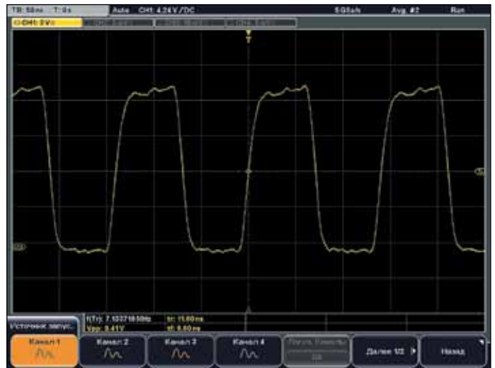
Рис. 9. Осциллограмма выходного сигнала кольцевого генератора
