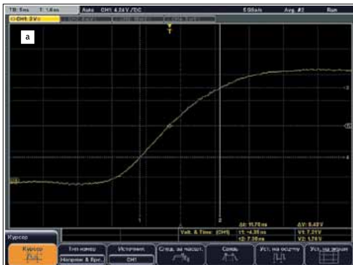
Рис. 10. Измерение длительности: а) фронта; б) спада выходного сигнала кольцевого генератора при помощи курсорных измерений
