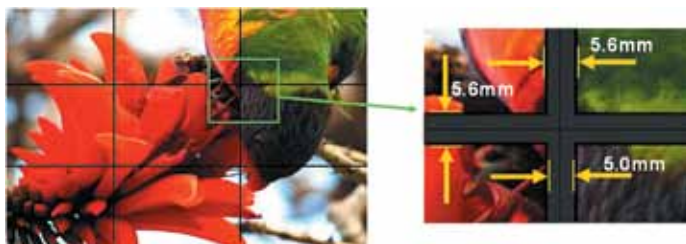
Рис. 7. Благодаря минимальной ширине межпанельных швов видеостена на основе дисплейных панелей AUO отличается высоким качеством изображения
