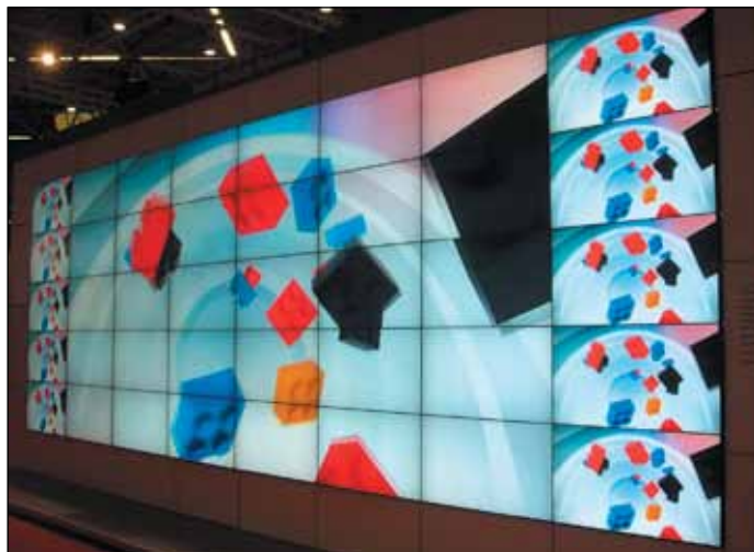
Рис. 2. Видеостена на базе TFT ЖК дисплейных панелей
