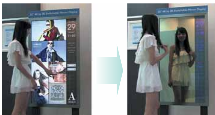
Рис. 8. Два режима Smart Mirror: а) дисплейный режим; б) режим зеркала (с информационным полем справа)
