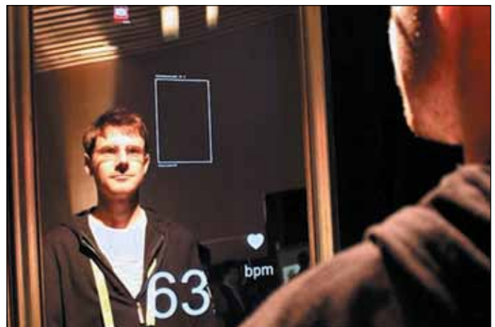
Рис. 12. Интерактивная система Smart Mirror с функцией измерения частоты пульса (только по анализу изображения) и с отображением частоты пульса на экране
