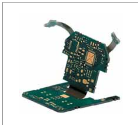
Рис. 1. Гибко-жесткая печатная плата
