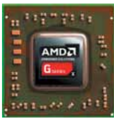
Рис. 1. Система G-Series SOC компании AMD содержит на одном кристалле ЦПУ, графический процессор и контроллер ввода/вывода
