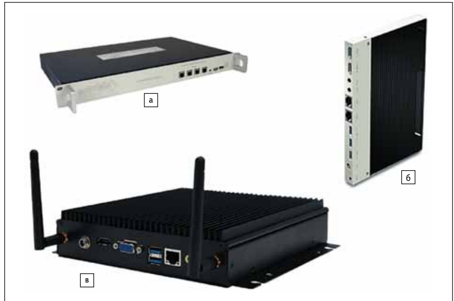
Рис. 3. Системные решения, предназначенные для поддержки сетевых приложений, цифровых информационных панелей и решения задач автоматизации, на основе кристалла AMD G-Series SOC от компаний: а) Deciso; б) IBASE; в) AEWIN
