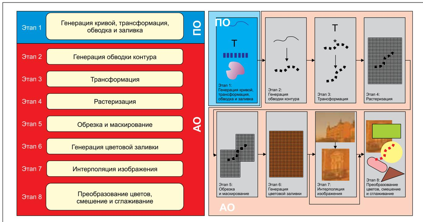
Рис. 4. Графическая подсистема с поддержкой стандарта OpenVG: ПО — программное обеспечение; АО — аппаратное обеспечение
