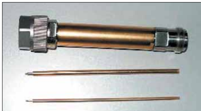
Рис. 3. Коаксиальные линии с воздушным диэлектриком с волновым сопротивлением 50 и 75 Ом
