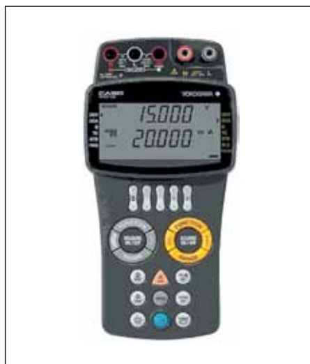
Рис. 21. Внешний вид переносных калибраторов Yokogawa CA150
