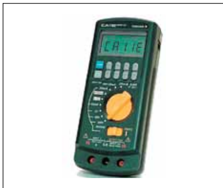
Рис. 19. Внешний вид переносных калибраторов Yokogawa CA11E/CA12E
