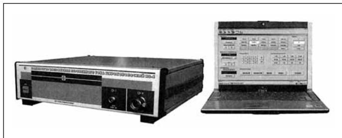
Рис. 16. Сверхширокополосный калибратор Н5-6 — приставка к ПК
