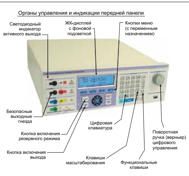
Рис. 17. Внешний вид настольного калибратора серии 3000 компании Transmille
