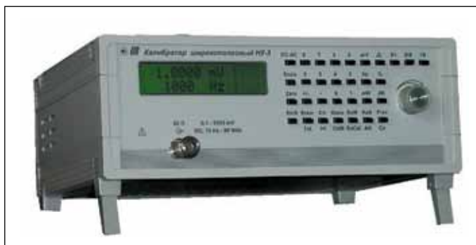
Рис. 15. Широкополосный калибратор Н5-3
