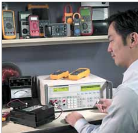
Рис. 9. Рабочее место с настольным калибратором Fluke
