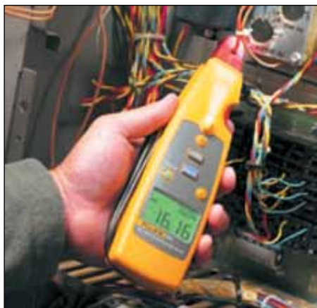
Рис. 24. Измерение тока в одиночном проводе бесконтактным методом
