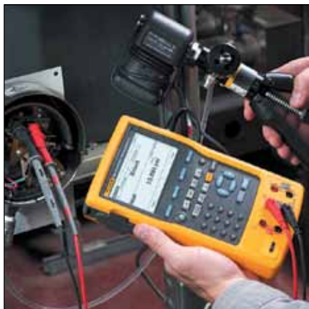
Рис. 35. Работа с калибратором давления в производственных условиях
