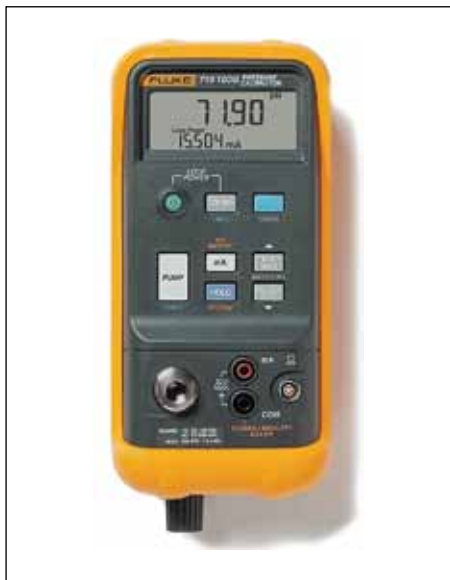
Рис. 36. Калибратор давления Fluke-719 со встроенной помпой (насосом)
