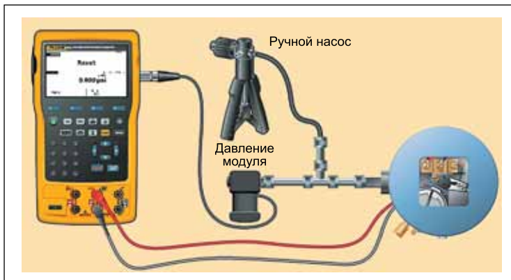
Рис. 34. Включение обычного калибратора давления
