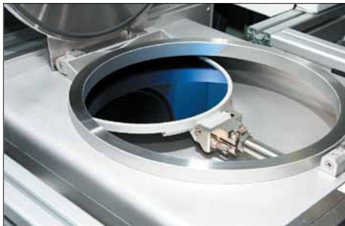
Рис. 6. Перемещение подложки из узла боковой загрузки в реакционную камеру
