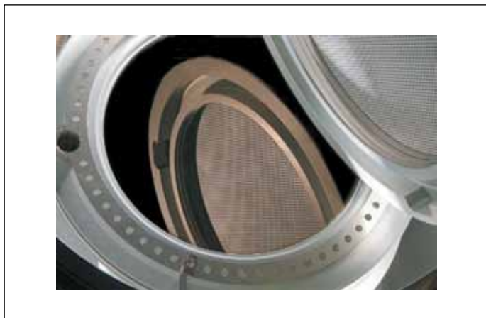
Рис. 5. Опция плазмы в реакционной камере TFS 200
