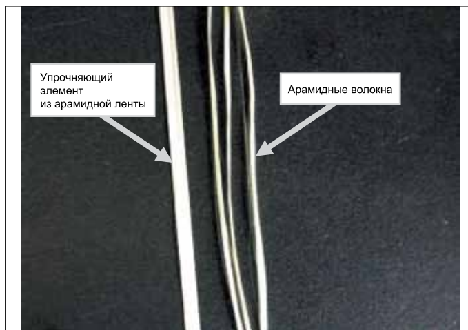
Рис. 3. Новый геометрический упрочняющий элемент в сравнении со свободно уложенными упрочняющими волокнами
