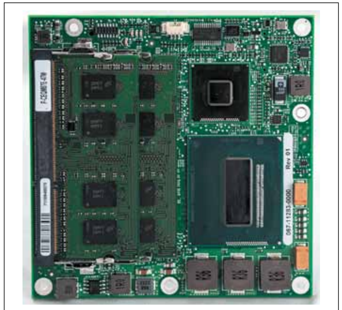
Рис. 2. Процессорный модуль CEQM87 с процессором Intel Haswell
