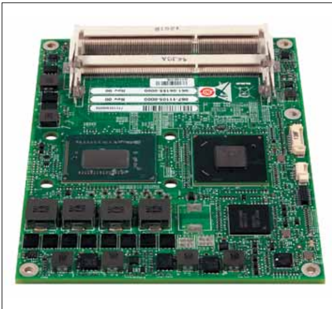
Рис. 1. Процессорный модуль CEQM77 с процессором Intel Ivy Bridge
