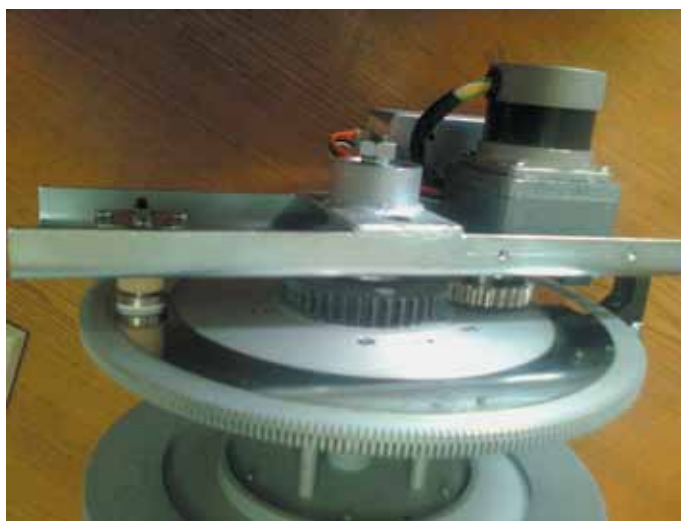
Рис. 6. Пример выполнения фрикционного тормоза (с разрешения ООО «Модуль-98»)
