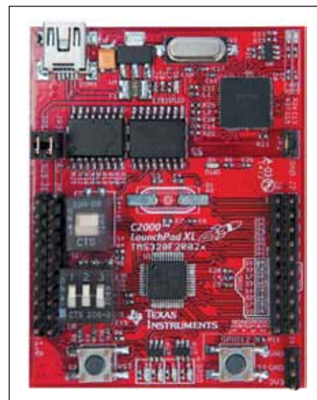
Рис. 6. Отладочное средство C2000 LaunchPad
