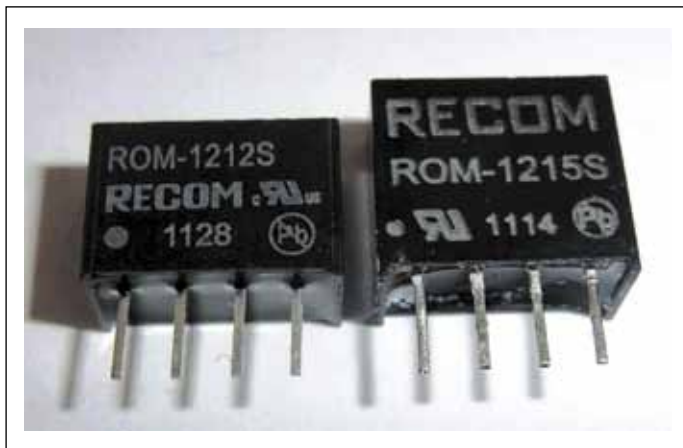
Рис. 3. Поддельный RECOM ROM-1215S с фальшивыми логотипом компании и значком сертификации UL (справа)
