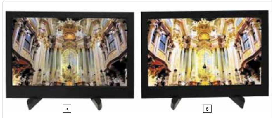
Рис. 11. Сравнение качества изображения на тестовом 10,8-дюймовом ЖК-дисплее формата FWXGA: а) обычная панель с матрицей a-Si; б) разработанная панель с матрицей IGZO-транзисторов
