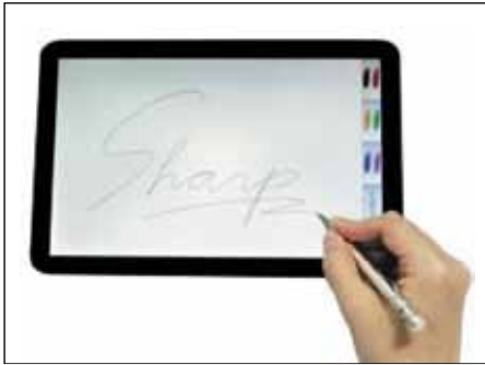
Рис. 14. Прототип сенсорной емкостной панели Sharp с высоким разрешением, реализованный для 10,1-дюймового WXGA ЖК-дисплея с технологией IGZO
