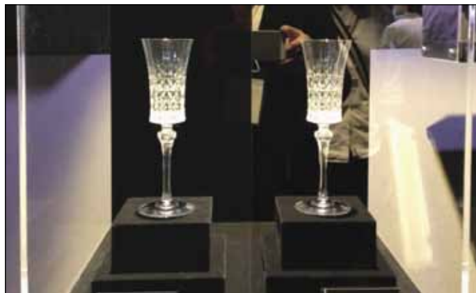
Рис. 6. За бокалом слева установлен поглощающий фильтр по технологии Moth-Eye (отражения нет), а справа — обычный антибликовый фильтр
