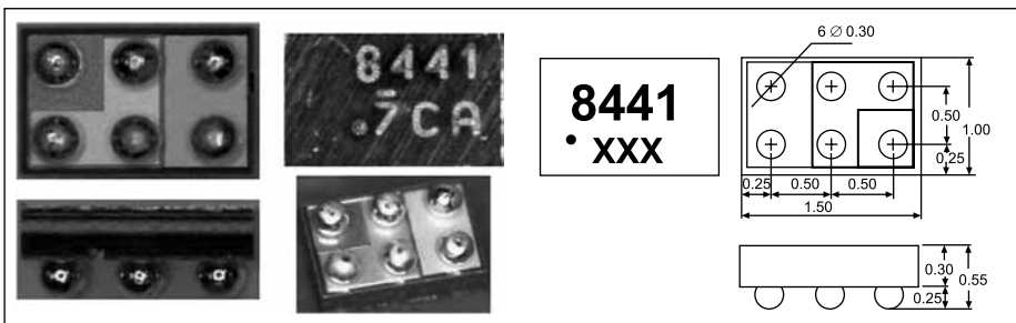
Рис. 7. Топология выводов полевого транзистора в корпусе MICRO FOOT
