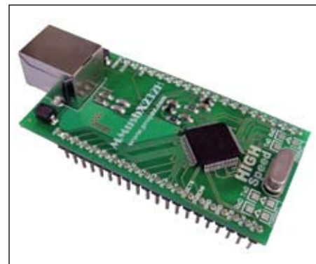
Рис. 2. Модуль MMusbX232H на основе микросхемы FTDI FT2232H
