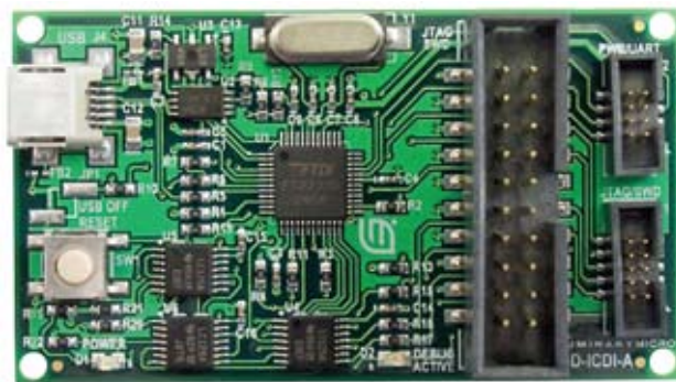
Рис. 2. Интерфейсная плата для внутрисхемной отладки
