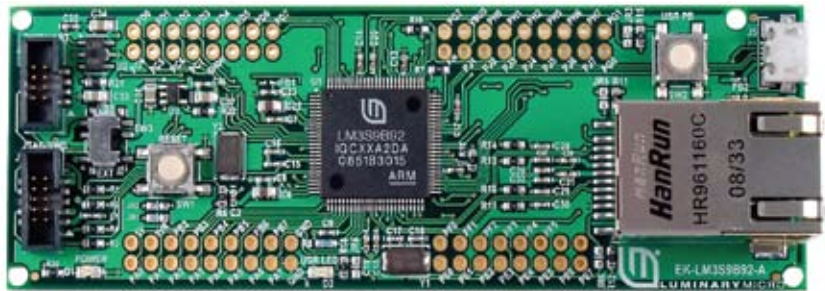
Рис. 1. Оценочная плата EK-LM3S9B92 Texas Instruments
