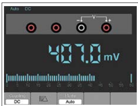
Рис. 22. Экран осциллографа при использовании мультиметра (пример измерения напряжения)
