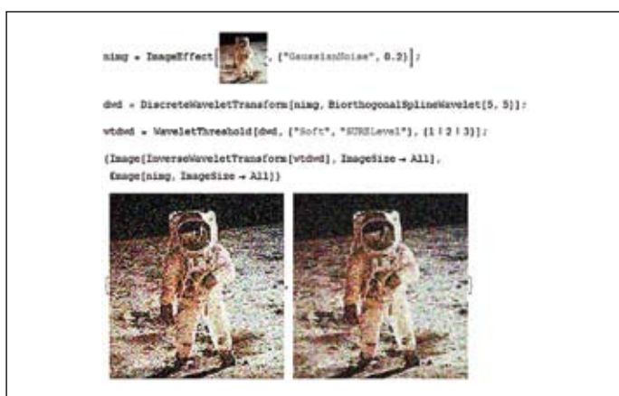
Рис. 23. Пример очистки от шума реального изображения
