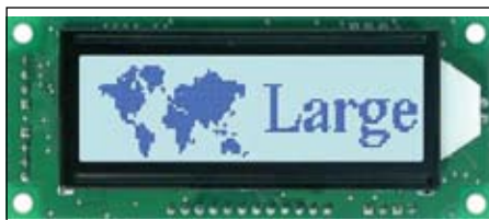
Рис. 7. Графический ЖК-модуль Matrix Orbital без тачскрина
