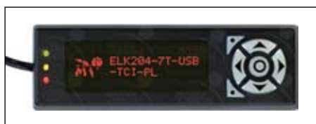
Рис. 3. Индикаторный ЖК-модуль серии External с передней панелью и функциональной клавиатурой (семь кнопок навигации на основе пленочной клавиатуры)
