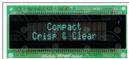
Рис. 4. Катодолуминесцентный индикатор серии MOI-AV162A-NT (с индикаторной лампой Noritake)
