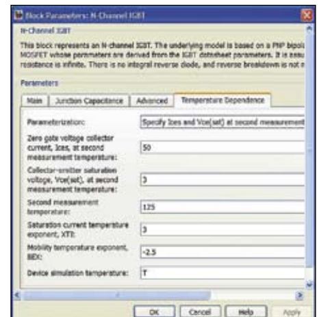
Рис. 24. Окно параметров IGBT с открытой вкладкой Temperature Dependence
