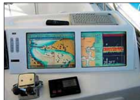
Рис. 13. Монитор серии NPD, встроенный в аппаратуру морской навигационной системы
