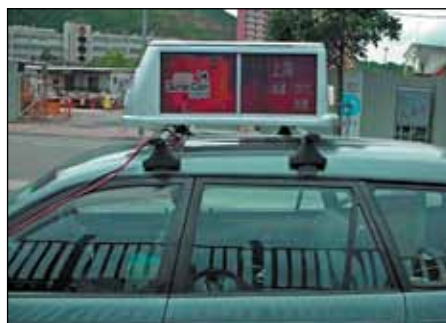
Рис. 7. Рекламное табло на крыше автомобиля на базе двух 17-дюймовых панелей серии ALH1745
