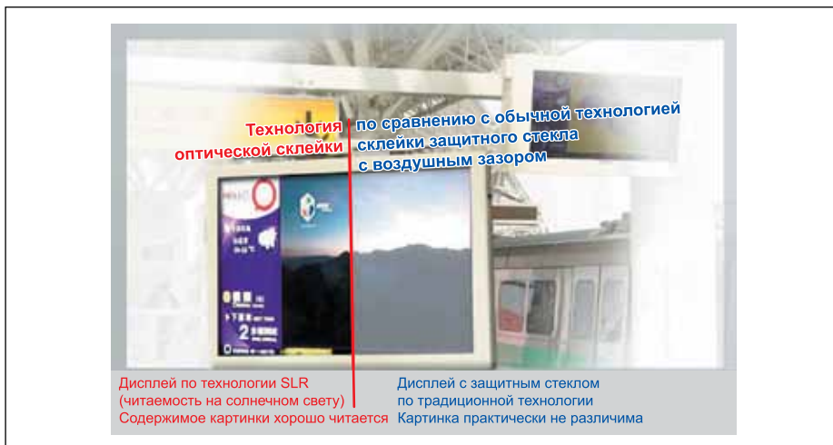
Рис. 5. Сравнение качества изображения дисплеев, изготовленных по технологии SLR+AOT, с обычной дисплейной технологией
