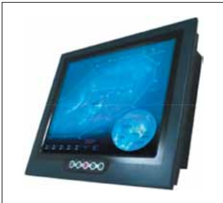
Рис. 14. Панельный компьютер серии NPSxx для морских приложений
