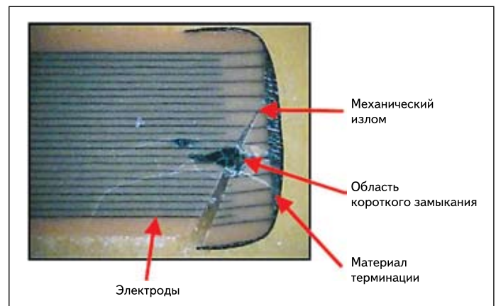
Рис. 4. Короткое замыкание при механическом дефекте
