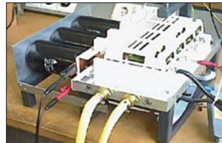
Рис. 6. Внешний вид сборки преобразователя со специализированным IPM SKiiP
