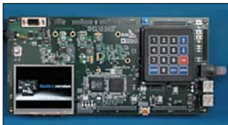
Рис. 3. Внешний вид оценочной платы ADSP BF527 EZ KIT Lite
