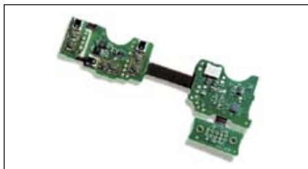
Рис. 3. Заготовка с гибкими печатными платами
