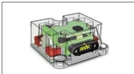
Рис. 4. Компоновка модуля STIM
