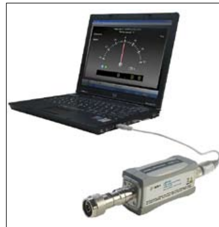
Рис. 26. Измеритель мощности на основе ноутбука и сенсора мощности серии U2000
