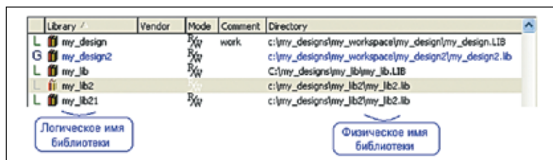
Рис. 15. Менеджер библиотек присоединил к активному проекту ту же самую физическую библиотеку my_lib2 под новым логическим именем my_lib21
