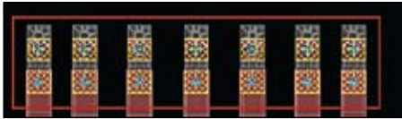
Рис. 10. Перемещение контактных площадок к концам линий
