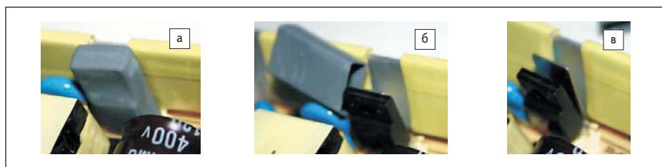
Рис. 4. а) Полевой транзистор в силиконовой оболочке прижат к радиатору (прижим не показан); б) цельнопластмассовый корпус полевого транзистора уменьшает стоимость монтажа; в) заземленный электростатический экран уменьшает помехи
