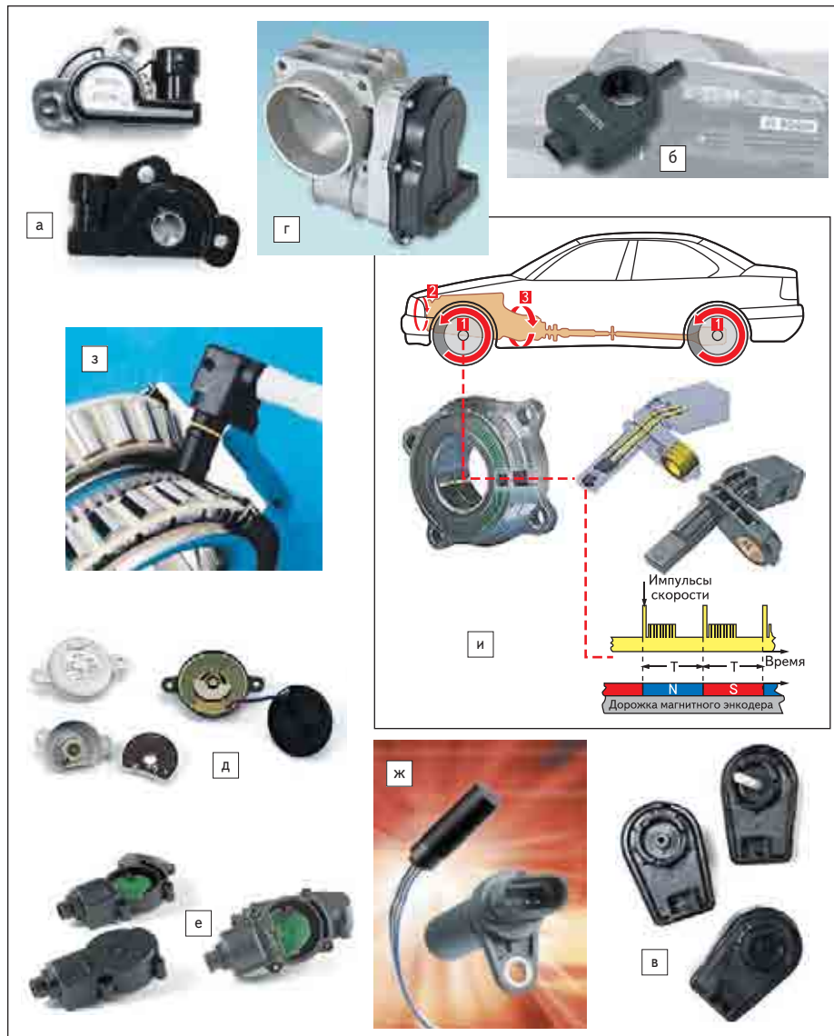
Рис. 1. Типичные примеры современных автомобильных датчиков положения/скорости/направления: а — потенциометрические датчики положения дросселя и педали серии 525 CTS Corporation; б — датчик угла поворота руля Bosch на основе принципа ГМР; в — датчик положения сиденья серии 240 CTS Corporation; г — электронный дроссель Delphi с бесконтактным датчиком; д — датчики выбора передач и контроля положений сцепления Novotechnik; е — датчики положения колес Novotechnik; ж — датчик скорости и направления на основе эффекта Холла для коробки передач, определения частоты вращения колес SD1002-1012 Cherry Electrical Products; з — датчик Холла SSI Technologies в АБС; и — датчики AMP с магнитным ротором Continental Teves для коробки передач, АБС и контроля скорости двигателя
