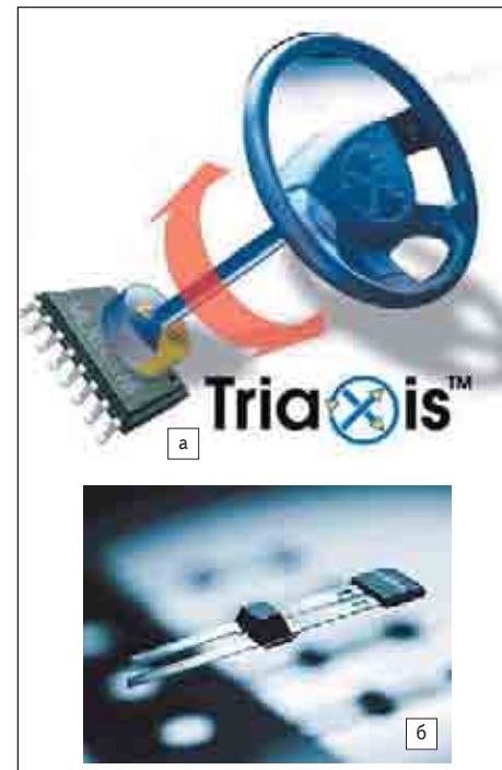
Рис. 2. Актуальные примеры современных интегральных датчиков Холла для измерения положения/скорости/направления: а — MLX90316 Melexis с малым дипольным магнитом — полностью интегральное решение для любых автомобильных систем детектирования положения; б — TLE4953 Infineon — интегральный цифровой датчик скорости и направления на основе эффекта Холла
