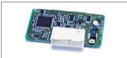
Рис. 76. Блок контроля расстояния АКК Denso (ECU)
