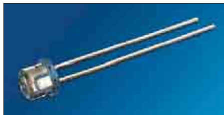
Рис. 67. Лазерный диод OSRAM в 5-миллиметровом полукруглом пластмассовом корпусе (SPL PLxx)
