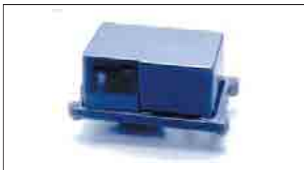
Рис. 75. Лидарный датчик Denso для систем АКК
