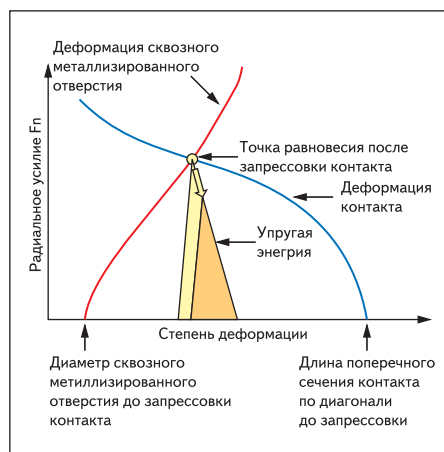
Рис. 9. Взаимозависимость степени деформации сочленяемых элементов и усилия запрессовки
