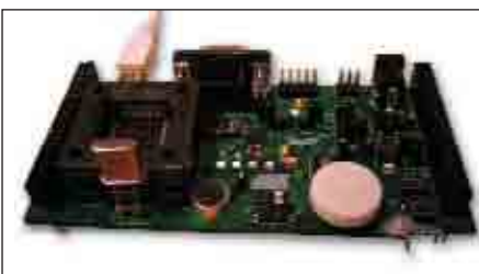
Рис. 7. Набор разработчика STK525
