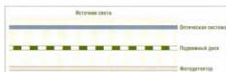
Рис. 12. Интерферометрический метод создает тонкие параллельные полосы света на очень коротких расстояниях
