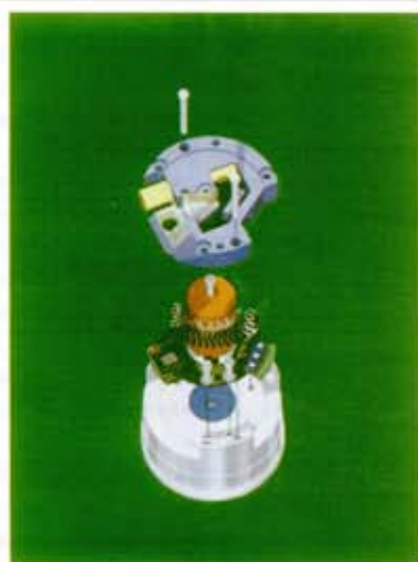
Рис. 10. Для обеспечения стабильности оптической системы все компоненты: светоделительная пластина, отражатели и источник света — установлены на прочном алюминиевом основании
