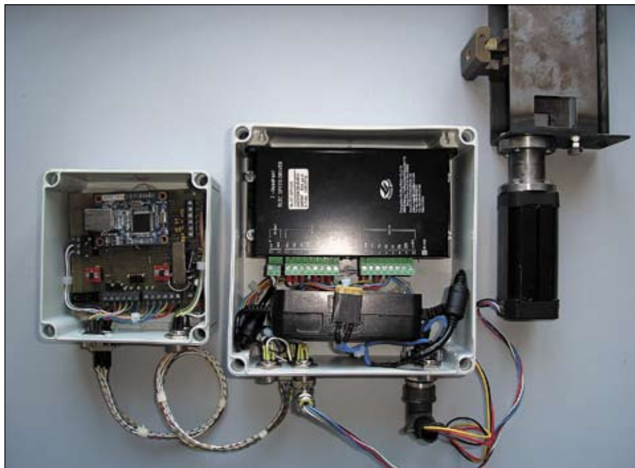
Рис. 3. Опытный образец контроллера бесколлекторного двигателя постоянного тока
