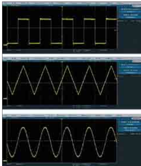
Рис. 2. Прямоугольный, треугольный и синусоидальный сигналы на выходе синтезатора DDS
