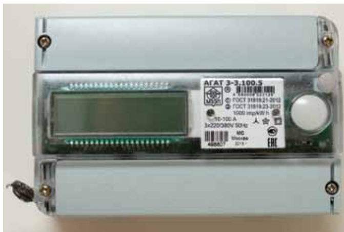
Рис. 3. АГАТ-3 – трехфазный однотарифный/многотарифный счетчик
